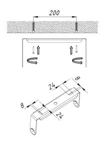
2. Закрепить светильник на лире (кронштейне) выставить нужный угол и зафиксировать.
