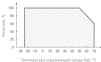
Рис. 2. Максимальная допустимая нагрузка, % от мощности источника.
